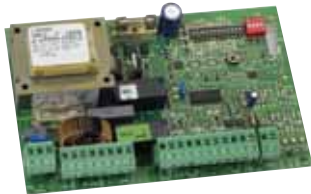
Steuerung 452 MPS Technische Daten auf Seite 151
