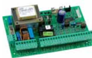
Steuerung 462 DF Technische Daten auf Seite 153
