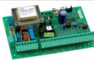
Steuerung 462 DF Technische Daten auf Seite 153
