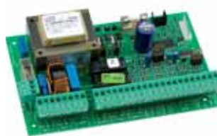
Steuerung 462 DF Technische Daten auf Seite 153
