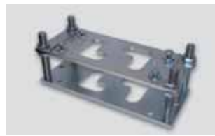
Motorkonsole zum Aufdübeln, höhenverstellbar max. 120 mm, horizontal und vertikal justierbar
