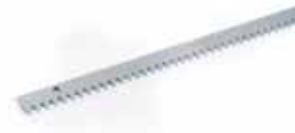
Stahlzahnstange verzinkt 30x8 Modul 4 mit Montagmaterial schweißbar (für Torgewicht max. 400 kg)
