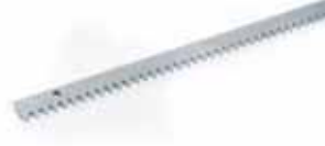
Stahlzahnstange verzinkt 30x8 Modul 4 mit Montagmaterial schraubbar (für Tore bis 400 kg)
