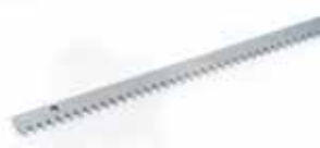
Stahlzahnstange verzinkt 30x8 Modul 4 mit Montagematerial schweißbar (für Tore bis 400 kg)
