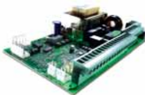
Steuerplatine 624 BLD integriert
